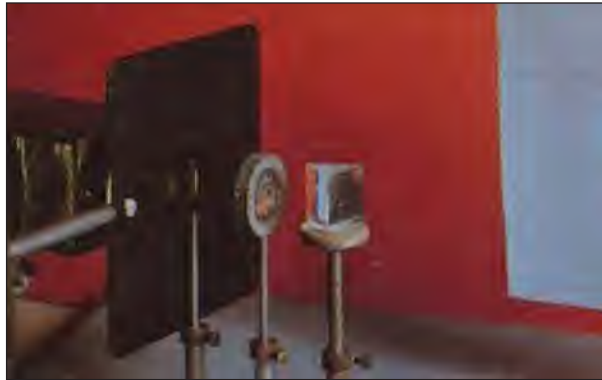
4. Dispositif expérimental permettant de décomposer la lumière blanche
