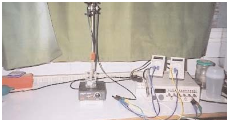
Figure 3b. Dispositif expérimental permettant de mesurer la conductance d'une solution électrolytique
