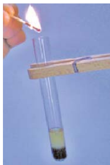
Figure.2b : Identification du dihydrogène gaz
