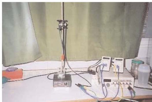
Figure 4. Montage électrique pour la détermination de la conductance.
