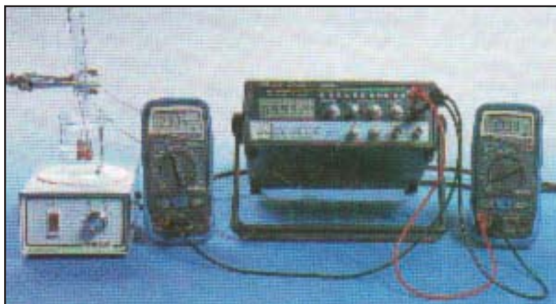
Figure 3b. Dispositif expérimental permettant de mesurer la conductance d'une solution électrolytique
