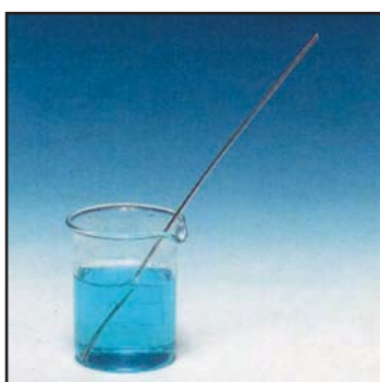
Figure 3. L'argent métallique ne réagit pas avec les ions cuivre (II)
