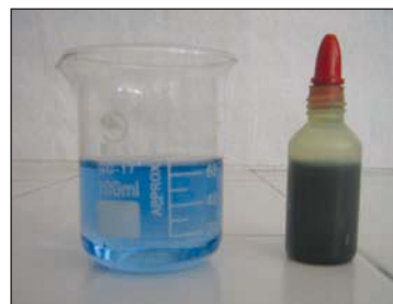
Le B.B.T initialement vert vire au bleu en présence d'une solution aqueuse d'amine.
