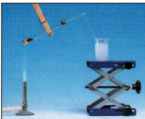
Figure 5. Réaction entre l'oxyde de cuivre (II) et le carbone
