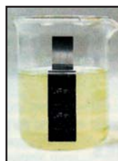
Figure 5. Réaction du fer métallique avec les ions argent
