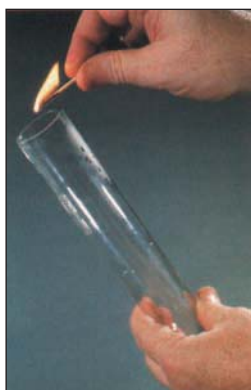
Figure 3b. Identification du dihydrogène gaz
