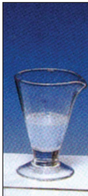
Figure 3b. Test à l'eau de chaux
