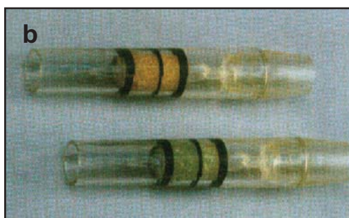
Figure 18 b. Dans le tube le réactif initialement jaune orangé vire au vert en présence d'alcool
