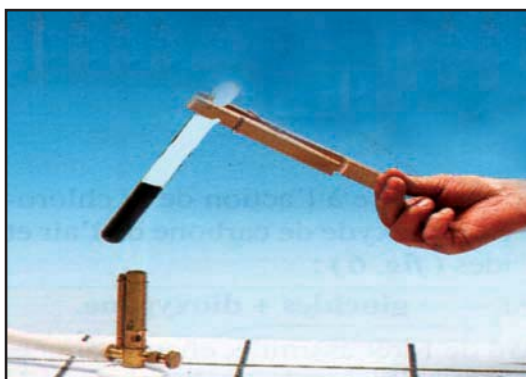
Figure 1. Pyrolyse de la sciure de bois
