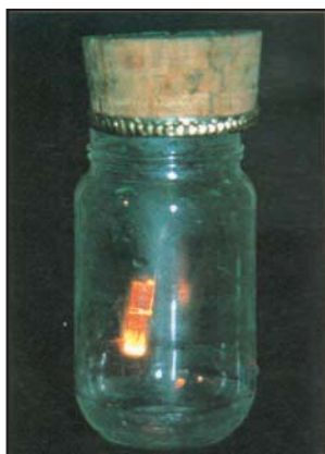
Figure 2. Réaction du charbon avec le dioxygène pur
